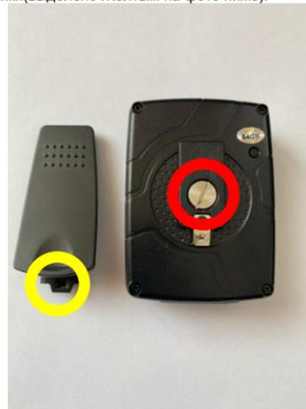
Пример выкручивания винта обратной стороной прищепки ниже на фото.
